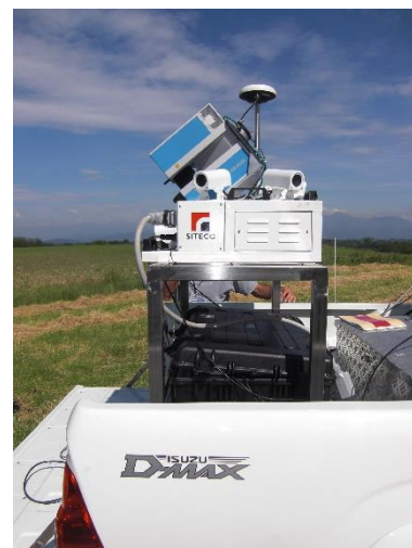
Figura 36 - Progetto Rilievo Mobile - Attrezzatura installata sul veicolo per il monitoraggio
