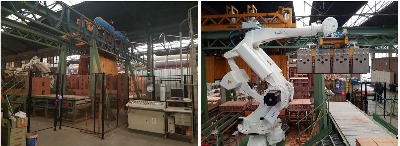
Fig.11-12 Rep. Imballo: formazione del pacco con pinze e robot
