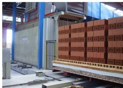
Fig. 9 - Uscita forno a tunnel
