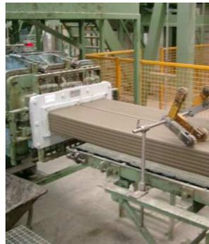
Fig. 5 - Estrusione e marcatura
