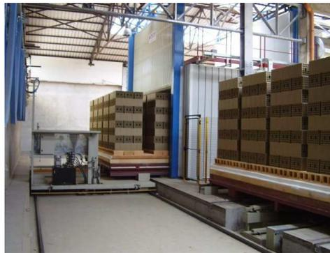
Fig. 7 - Ingresso forno a tunnel
