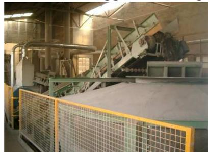
Fig. 3 - Prelavorazione terra Molazza e laminatoio sgrossatore
