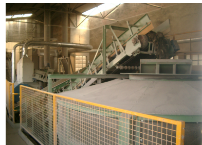
Fig. 4 - Prelavorazione terra Molazza e laminatoio sgrassatore
