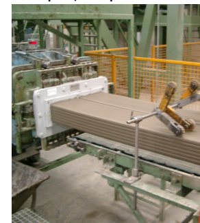
Fig. 6 - Estrusione e marcatura
