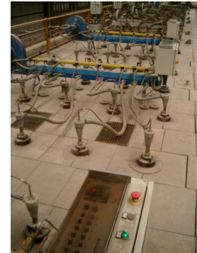
Fig. 10 – Gruppi di bruciatori su volta forno
