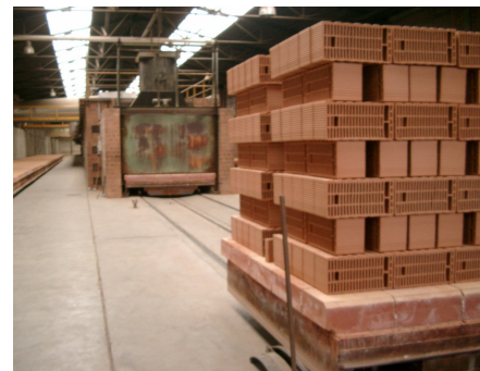
Fig. 11 – Uscita forno a tunnel
