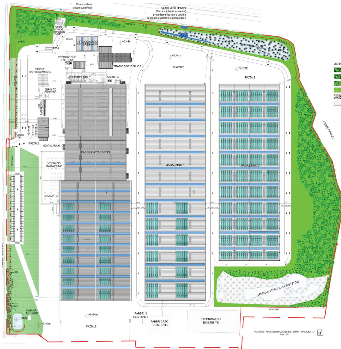
Fig. 5 – Schema tipologico dell'insediamento produttivo per la fabbricazione del vetro cavo
