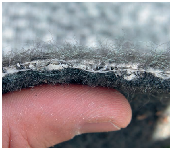
Visione di una sezione di "Volgrip", dotato di barbule autoaggancianti.
