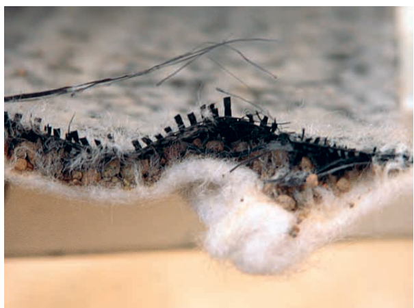
Particolare di un lembo di geotessuto impregnato di bentonite tipo “Bentomat 50”.
