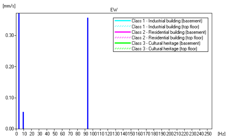
Figura 1.15 Distribuzione della velocità di oscillazione in funzione delle frequenze per la componente E-W con i riferimenti per le tre classi di edifici definiti dalla normativa.
