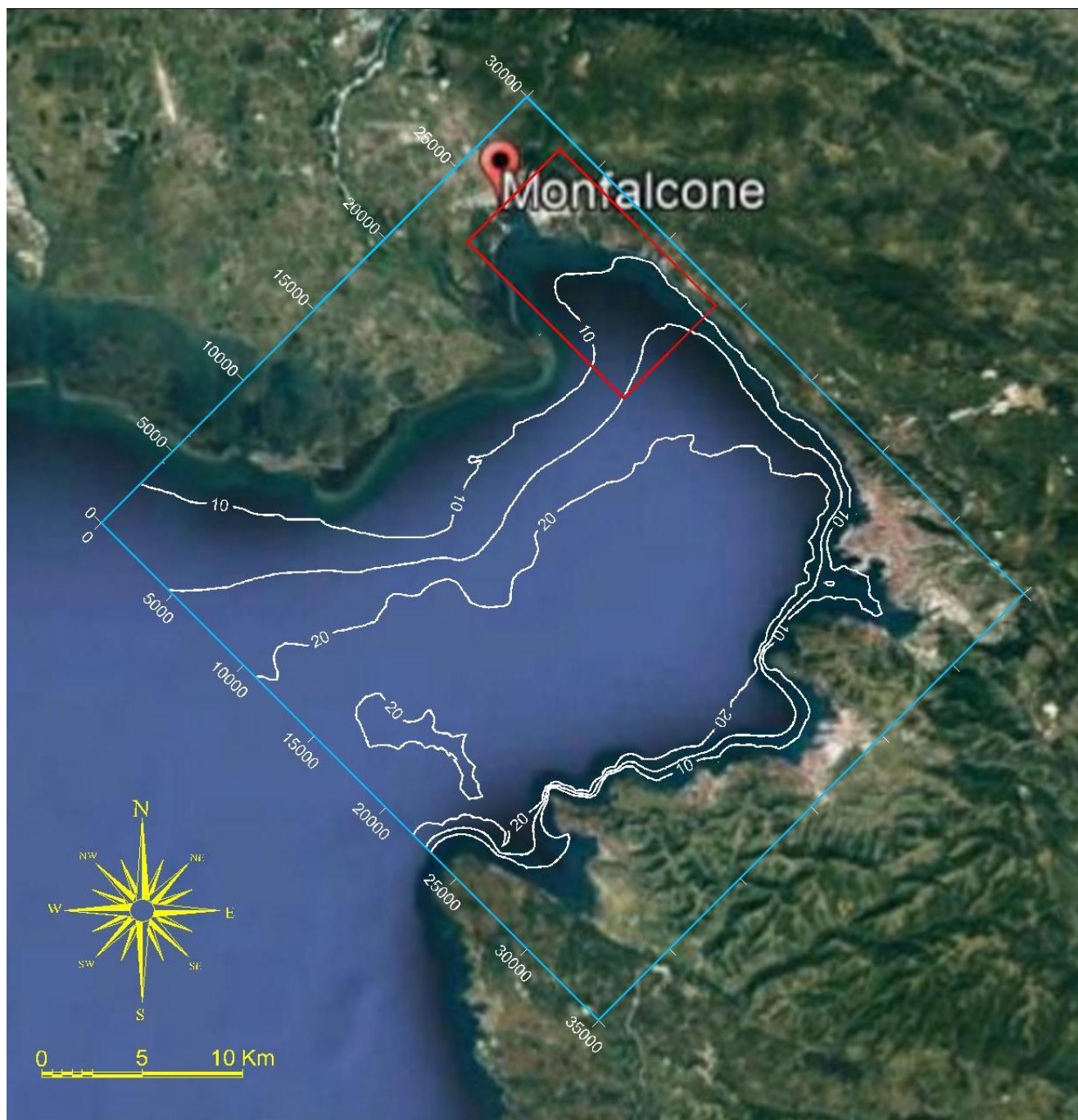
Figura 2 – Aree di calcolo utilizzata per l'applicazione del modello numerico SWAN. In celeste l'area di calcolo per le simulazioni relative al golfo di Trieste e in rosso quella per le simulazioni relative all'area portuale
